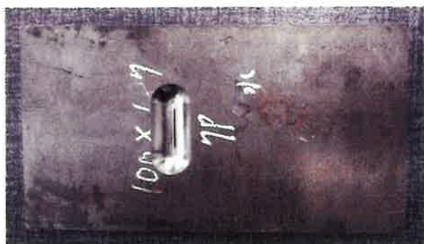
写真1 鋼板試験体 (t16) 板厚中央部のスリット
