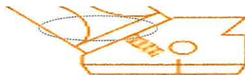
図8 t40-D (開先面側初層の欠陥) の平面画像
