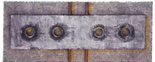
写真2 すべり試験後の滑り面（側板）
