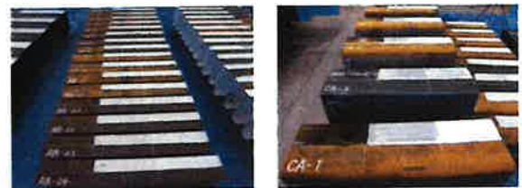
写真2 ケミカル剤塗布例
