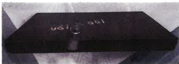
写真2 鋼板試験体 (t16) 板厚中央部の横穴
